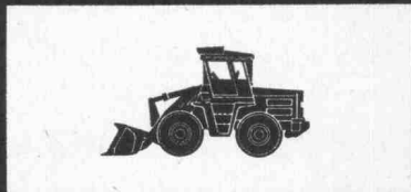
Radlader Europ L 800 Motor: 80 SAE-PS Schaufeln: 0,8 - 1,3 m³ Gewicht: 5800 kg
