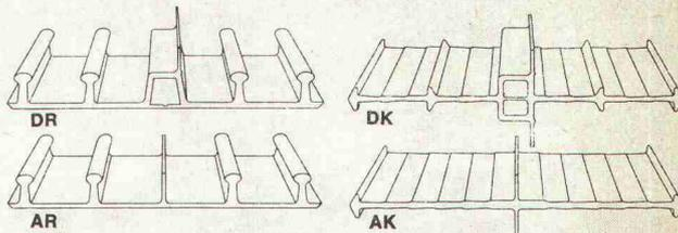
\*DR: für Dilatationsfugen, Einbau am Rande AR: für Arbeitsfugen, Einbau am Rande DK: für Dilatationsfugen, Einbau im Körper AK: für Arbeitsfugen, Einbau im Körper
