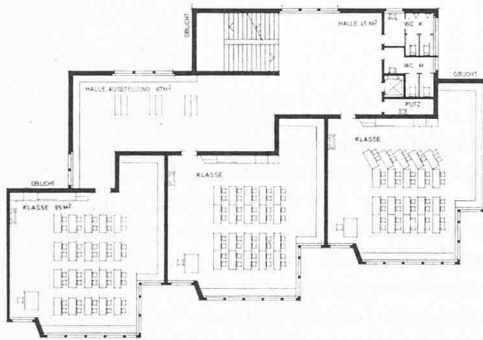
Erstes und zweites Obergeschoss 1:500: Klassentrakt 2 (grössere Klassenräume)
