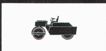
Vibrations-Tandemwalze VT M Statisches Gewicht: 4,9 t Arbeitsbreite: 1200 mm
