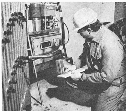
Bild 6, rechts. Einstellen des Kolbenhubes nach der Montage der Dose. Verständigung zwischen Kaverne und Messraum über Sprechfunk
