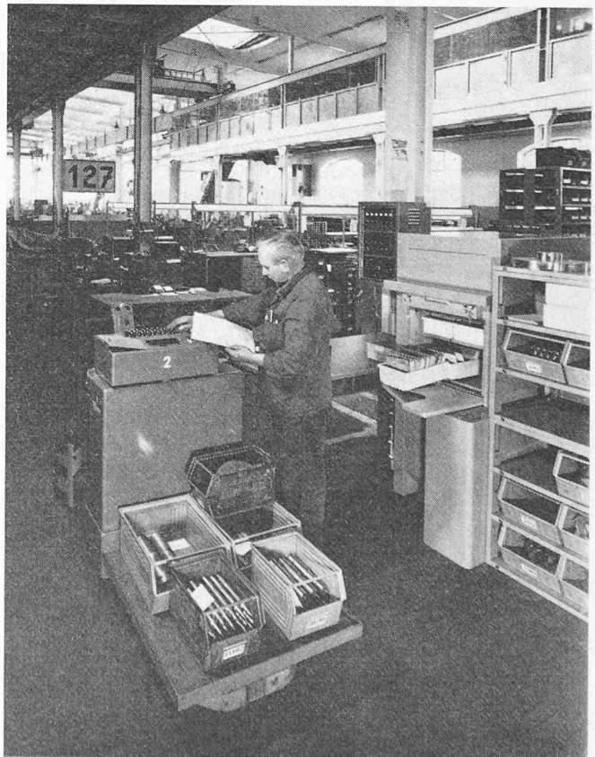
Bild 10. Die Verbindung von Fertigung, Kontrolle und Lager wird durch einen selbststeuernden Elektro-Plattformhubwagen vorgenommen, der seinen Weg an einer bodenversenkten Leitlinie findet und automatisch am Zielort aussteuert (Bild Wagner, Reutlingen)
