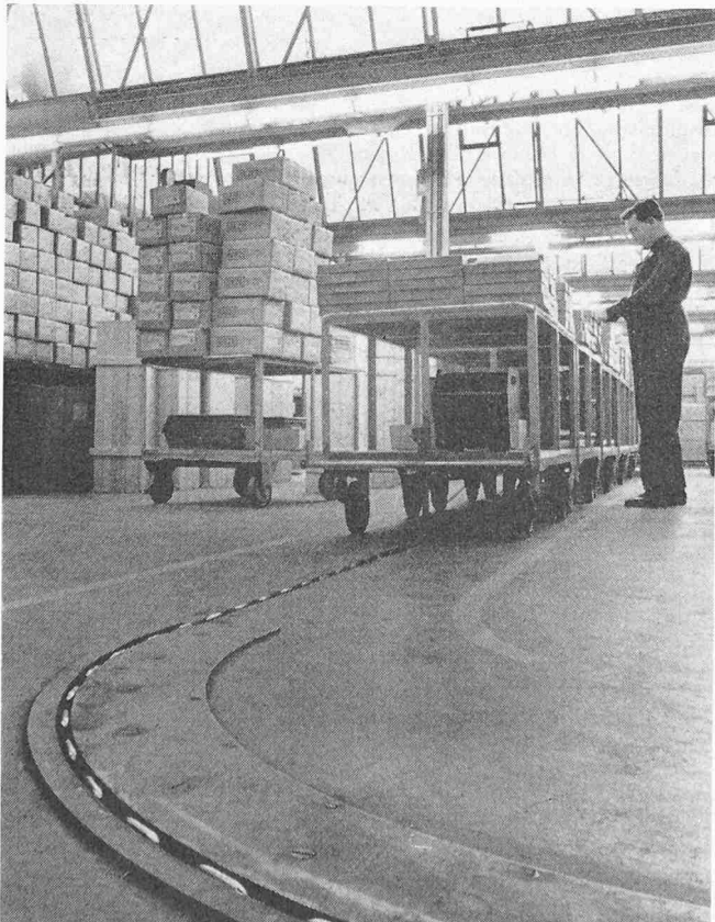
Bild 9. Mit einer bodenversenkten Förderkette werden die Sammelwagen des Lagers mit der Fertigung oder dem Versand verbunden. Mit Stift bekommen sie einen Zielsteuerungsbehehl, um an dem gewünschten Ort ausgeschleust zu werden (Bild Stotz)
