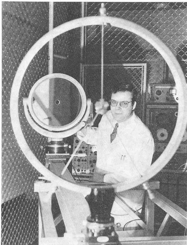
Bild 1. Cassegrain-Teleskop einer Kopfstation der Versuchsstrecke. Im Vordergrund der konvexe Okularspiegel. Das Bild zeigt die Empfangseinrichtung
