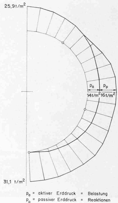
Bild 8. Resultierende Radialdrücke (Bettungsziffer  $C = 2,0 \text{ kg/cm}^3$ )
