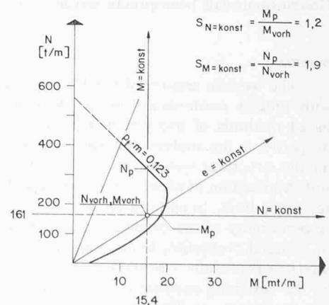
Bild 10. Interaktionsdiagramm der Ulmtübbinge
