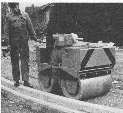
Bild 1. Doppel-Tandem Vibrationswalze DTV-12, Gewicht 850 kg, Walzendurchmesser 480 mm, Walzenbreite 700 mm, Mittelpunktklenkung-Doppelantrieb
