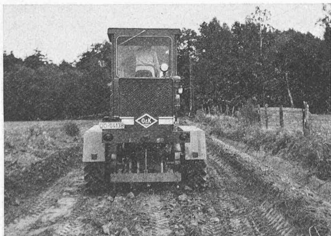
Bild 6. Aufreissen harter Bodenschichten
