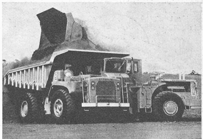
Bild 4. Eine 12-m 3 -Ladeschaufel belädt einen 50-t-Muldenkipper
