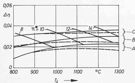
Bild 4, links. Thermischer Wirkungsgrad  $\eta_{th}$  in Funktion der Turbineneintrittstemperatur  $T_4$
