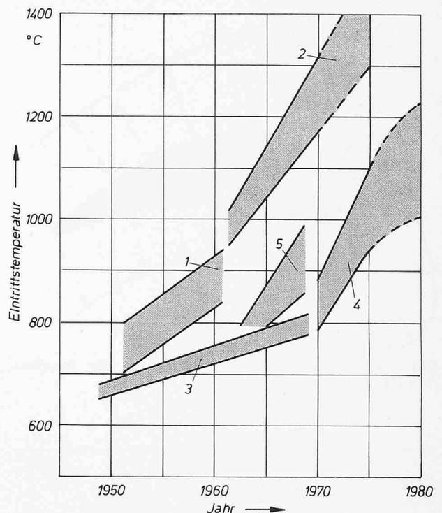
Bild 6. Steigerung der Eintrittstemperatur bei Flugtriebwerken und Industriegasturbinen
