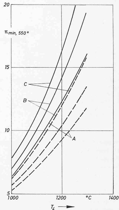
Bild 5. Minimal erforderliches Druckverhältnis  $\pi_{min}$  für eine Abgastemperatur  $T_5 \leq 550^\circ\text{C}$ , in Abhängigkeit von der Heissgastemperatur  $T_4$ , der Qualität der Prozessführung und dem Kühlluftverbrauch A, B, C vgl. Bild 3
