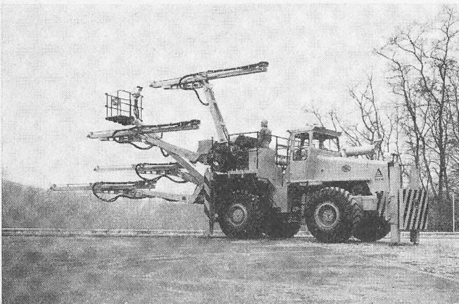
Vierarmiger SIG-Bohrwagen mit Ladbahn auf Knickgelenkfahrzeug, Type BAP 4-380 + L, mit Wirkungsfläche bis 47 m 2 Profilquerschnitt
