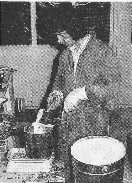
Bild 35. Abwägen der Harzkomponente der Klebmasse
