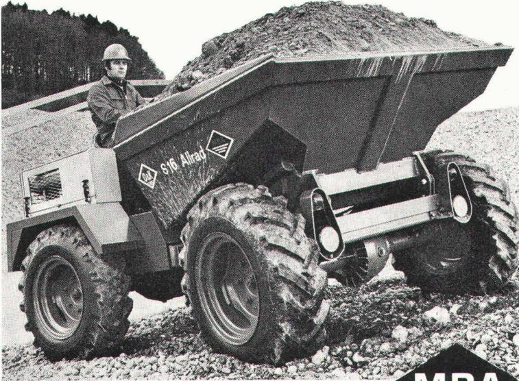
Ausgezeichnete Geländegängigkeit dank Allradantrieb, Wendegetriebe und 24,5-PS-Dieselmotor. Erstaunliche Manövrierfähigkeit durch hydraulische Knickrahmenlenkung. Wendekreis 1,65 m. Muldeninhalt 1,6 m<sup>3</sup> und 2,5 Tonnen Nutzlast. Grosses Ausrüstungsprogramm für jeden Einsatz.
