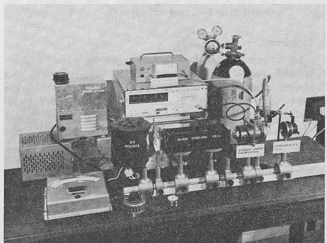
visuelle Beobachtung eines den Lampenstrom überwachenden Präzisions-Amperemeters konstant auf  $\pm 0,001\%$  gehalten wird. Nach Erhalt von Sensoranzeigen wird die Strahlintensität dadurch bestimmt, dass der Sensor durch eine mit einer UV-empfindlichen Lösung aus Kalium-Eisen-Oxalat gefüllten Zelle ersetzt wird, die nach dem bekannten von Parker [9], Hatchard und Parker [10] entwickelten, äusserst empfindlichen Verfahren arbeitet.
