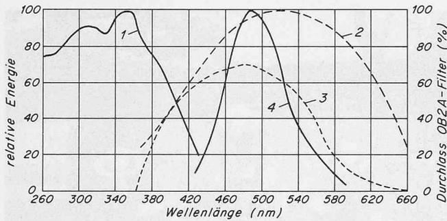
Bild 5. Erregungs- und Re-Emissionsspektren der Phosphorplatte
