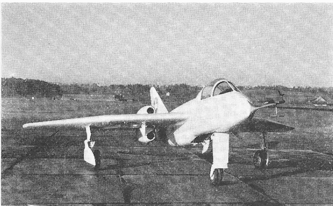
Bild 10. N-20.2 «Arbalète» auf dem Flugplatz in Emmen. Die Rumpfspitze ist mit verschiedenen aerodynamischen Messgeräten ausgerüstet
