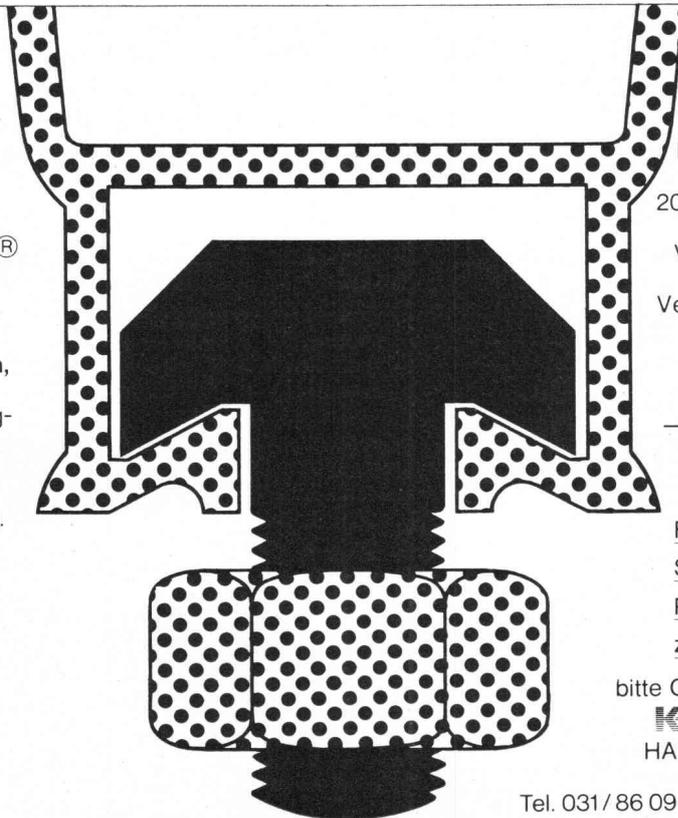
HALFENEISEN®-Ankerschienen mit Tragfähigkeit von 200 bis 12 000 kg pro Lfm und mit der einzigartigen Original-Vollschaumfüllung aus Styropor sind sofort ab Lager lieferbar. Verlangen Sie den neuen Katalog mit allen technischen Daten, sowie Anwendungsbeispielen.
