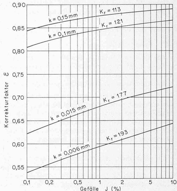
Bild 4. Korrekturfaktor  $\epsilon$  zur Berechnung von  $K$  ausserhalb des Gültigkeitsbereiches der Formel von Strickler.  $k$  Wandrauigkeit in  $m$ ;  $K_r$  Rauigkeitsbeiwert nach Strickler;  $D$  Innendurchmesser des Rohres.  $K = \epsilon K_r$ ;  $K_r = 26/k^{1/6}$ . Die Genauigkeit von  $K$  beträgt  $\pm 3\%$  bei  $0,3 < D < 1,0$  m
