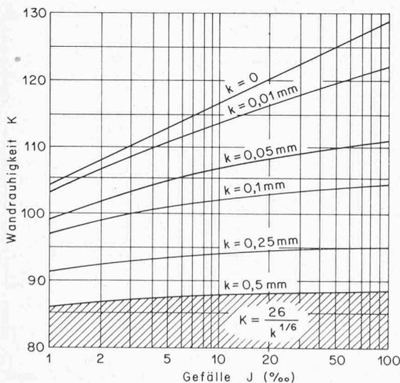
Bild 3. Rauhhigkeitsbeiwert  $K$  nach Strickler infolge des Druck-Energiegefälles  $J$ .  $D$  Durchmesser
