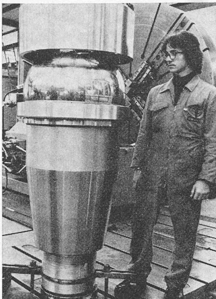
Bild 18. Zapfenlager bei der Vormontage
