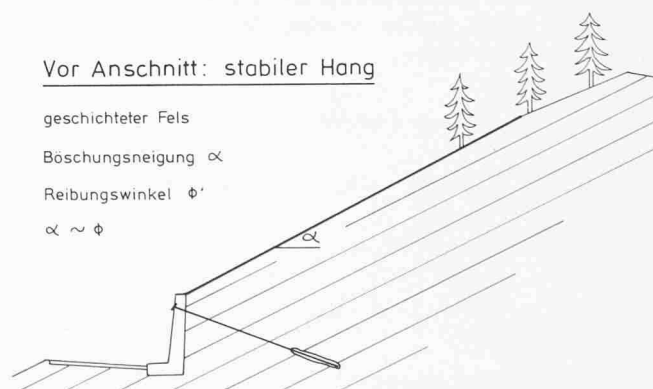
Bild 5. Einfluss eines Anschnittes in einem Hang mit einer Felsschichtung parallel zur Oberfläche für \alpha \sim \phi
