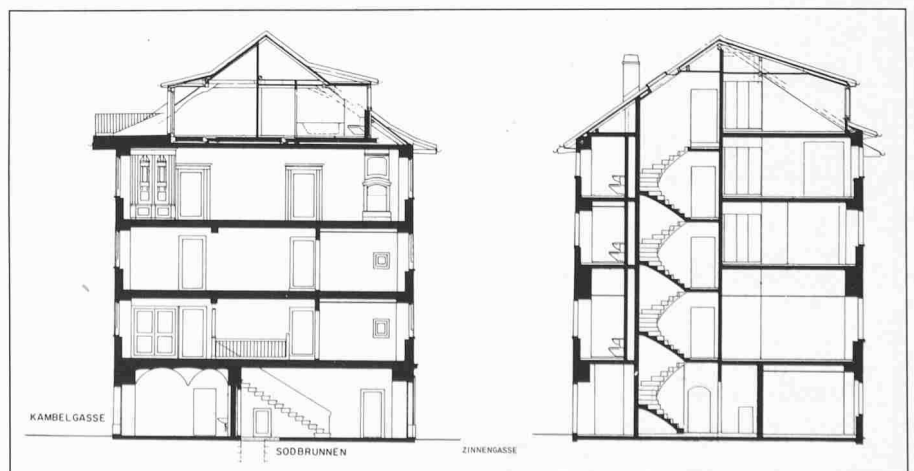
Links: Schnitt durch das «Neuhaus» nach der Restaurierung; rechts: Schnitt durch das Sigristenhaus nach der Restaurierung
