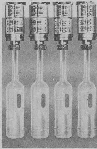
PVC-Getränkeflaschen mit Griff, auf der Bell-Blasformanlage gleichzeitig vierfach hergestellt.
