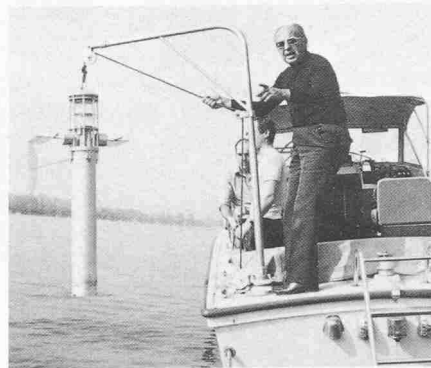
Bild 12. Messung von Seeströmungen. Testversuche mit einer Sonde gemäss Bild 11 im Zürichsee
