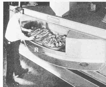
Bild 17C. Hilfsstation auf der Rückseite der Anlage gemäss Bild 17A für das Wenden der Werkstücke nach dem Durchgang unter dem ersten Schleuderrad. Bodenebene Aufstellung ohne Fundamentgrube.
