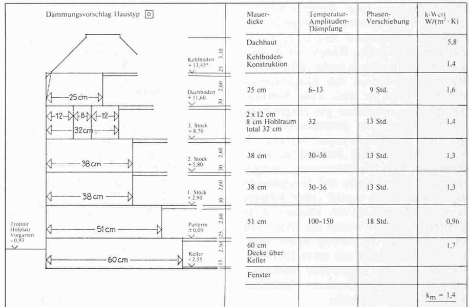
Bild 3. Schema der Wandstärken der Aussenmauer, Dach und Keller. Rechnerische Werte für Amplitudendämmung, Phasenverschiebung und k-Wert im Ist-Zustand: k<sub>m</sub> = 1,4 W/(m<sup>2</sup> · K)
