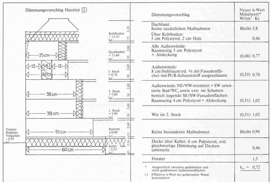
Bild 4. Schema der Wärmedämmung Typ 1. k-Wert verbessert auf 0,72 W/(m<sup>2</sup> · K) für k<sub>m</sub>. Die spezifische Heizleistung beträgt nur noch 71 W/K je Wohnung
