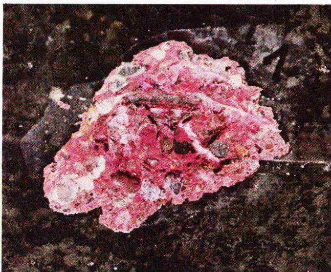
Brücke A. Keine Spur von Karbonatisierung im Alter von 42 Jahren! Der Verbund zwischen Stahleinlage und Beton ist gesund
