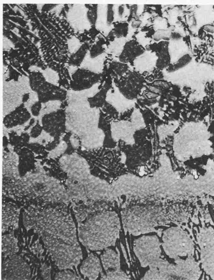
Dieselmotorauspuffventil mit gepanzelter Sitzfläche: Auf die Stelliteunterlage (Kobaltbasis mit Chrom-Wolfram-Karbid-Netzwerk) ist eine Superlegierung als Korrosionsschutzschicht (oben) aufgespritzt. Um das Mikrogefüge im Farbkontrast sichtbar zu machen, wurde die Verbindungszone im Vakuum mit Zinkselenid bedampft
