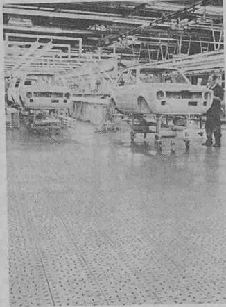
rende Reparaturen werden vermieden. Zerstörte Betonfugen können mit den Ankerplatten saniert werden. Das Bild zeigt einen Bodenbelag mit Stelcon-Ankerplatten in der Schwerindustrie. Hier werden relativ hohe Gewichte auf kleinen Flächen bewegt und abgestellt. Ein Teigwagen in einer Bäckerei stellt an den Boden ebenfalls hohe Ansprüche, deshalb finden wir auch hier immer mehr stahlgepanzerte Betriebsflächen.
