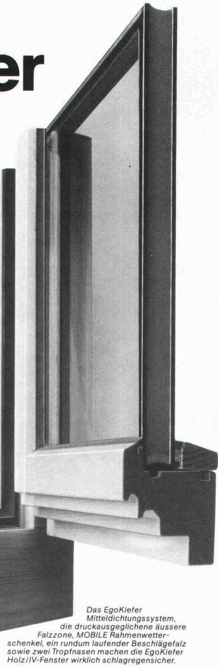
Das EgoKiefer Mitteldichtungssystem, die druckausgeglichene äussere Falzzone, MOBILE Rahmenwetter-schenkel, ein rundum laufender Beschlägefalz sowie zwei Tropfnasen machen die EgoKiefer Holz/IV-Fenster wirklich schlagregensicher.
