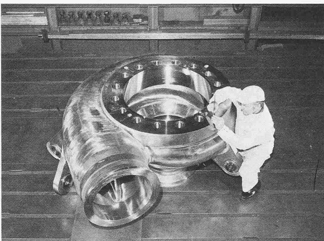
Bild 25. Hauptkühlmittel-Pumpengehäuse zu Siedwasser-Reaktor mit eingossener Trennwand. Gewicht fertig bearbeitet 7,0 t
