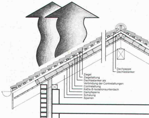
Das Dach ist als «Energieverschwender» bekannt. Rund 1/3 des Wärmeverlustes entweicht durchs Dach. Hier muss die Wärmedämmung verbessert werden. Mit dem KeDa-S haben wir die Lösung gefunden:
