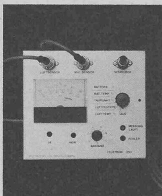
Parameter. Anschluss eines 4-Kanal-Schreibers ist möglich. Ein Netzgerät ist eingebaut, netzfreier Betrieb während einiger Stunden möglich.
