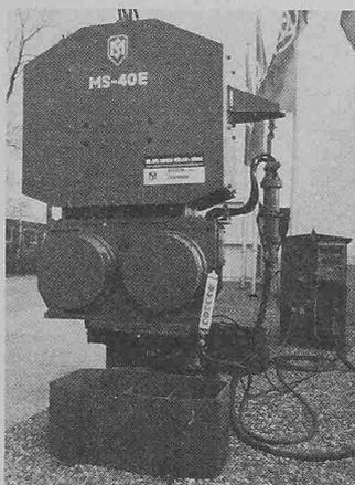
zur Hannover-Messe '81 u. a. den Elektrovibrator MS-40 E zum Rammen und Ziehen von Spundwänden, I-Trägern und Rohren in mittlere Böden für eine Tiefe von 16 bis 18 m. Das
