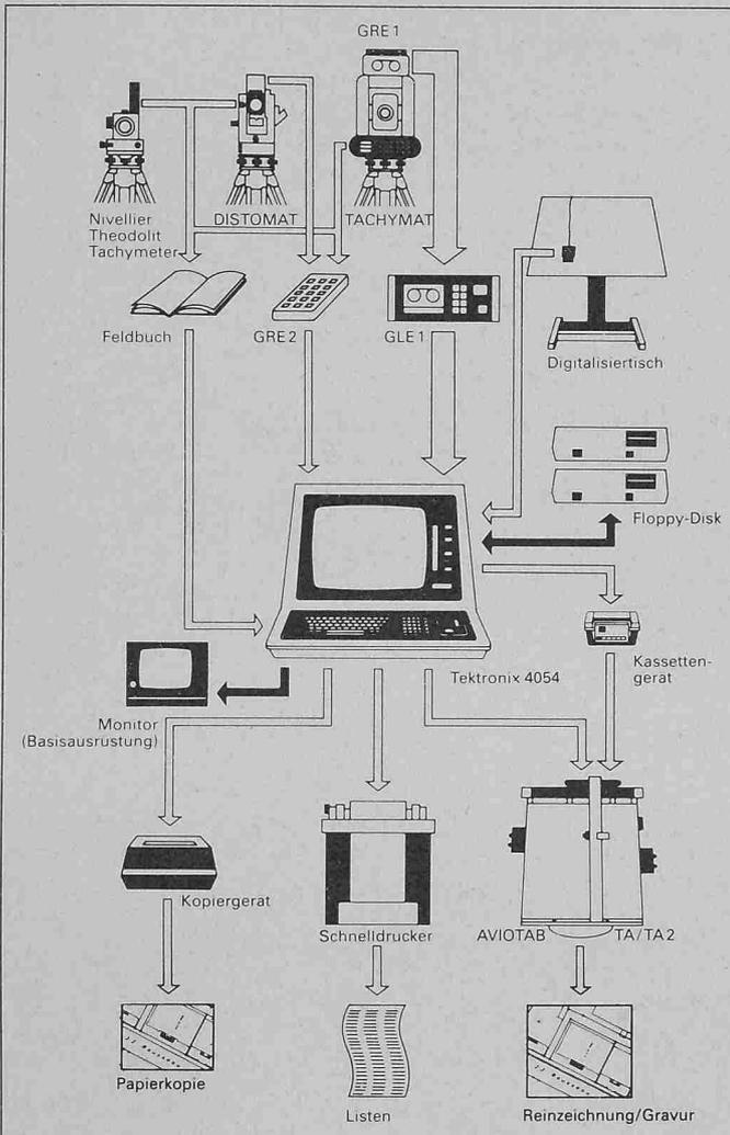
sowie die Bestimmung der System-Parameter, Symbole, Schriften, Linienarten usw. nach individuellen Bedürfnissen. Das Berechnungs-Subsystem umfasst alle Programme, die zur Bereinigung und Umwandlung der Felddaten in X, Y, Z-Koordinaten sämtlicher Punkte erforderlich sind. Das dritte Software-Subsystem beinhaltet die Programme für die interaktive graphische Bearbeitung sowie COGO-Funktionen. Damit wird der Plan gestaltet, editiert, beschriftet und gezeichnet.
