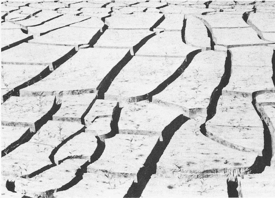
Bild 1. Kiesschlamm nach natürlicher Austrocknung im Kiesschlammweiher. Die breiten Trockenrisse deuten auf die hohe Feinheit des Abfallstoffes
