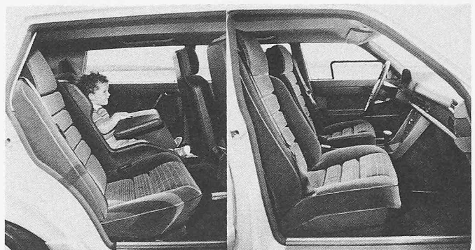
Bild 8. Komfort, Grosszügigkeit und hohe Insassensicherheit als Prinzip der Innenraumgestaltung des Forschungswagens von Daimler-Benz. Die Sitze sind mit Kopfstützen und Gurten zu einer Einheit zusammengefasst. Der austauschbare Kindersitz hat einen Pralltisch, der für grösstmögliche Bewegungsfreiheit und Sicherheit sorgt
