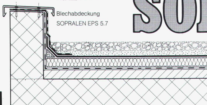
Schutzschicht SOPRALEN EJ 3.5 + EV 3.2 Wärmedämmschicht Dampfsperre
