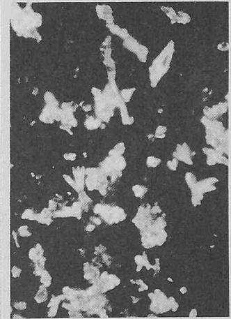
Kalkausfällung mit Crustex (600× vergrössert)
