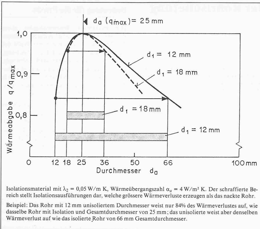
Bild 2. Wärmeabgabe  $q$  von isolierten Rohrleitungen verglichen mit dem maximal möglichen Wärmeverlust  $q_{max}$  in Funktion des Durchmessers  $d_a$
