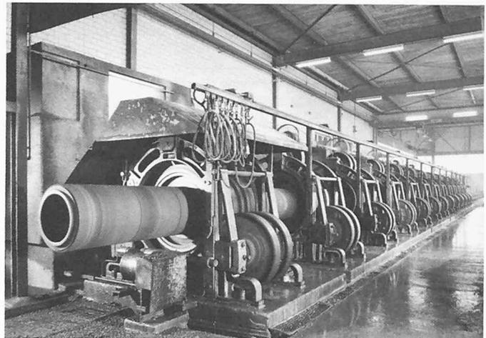
Bild 7. Schleudermaschine
