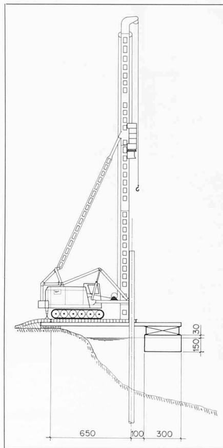
Bild 12. Rammern im Wasser, vom Ufer aus
