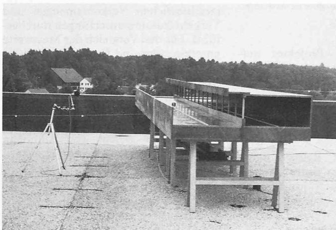
Bild 2b. Modell der Lärmschutzgalerie. Innenaufnahme. EMPA-Foto Nr. 78272/25
