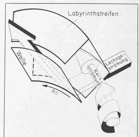
Bild 11. Strömung im Labyrinth
