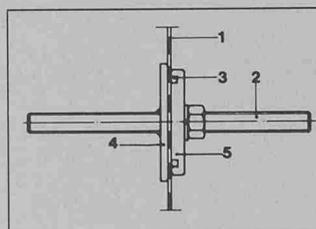
Befestigungsanker. 1 Kunststoffdichtungsbahn (KDB). 2 Anker. 3 O-Ring. 4 Festflansch. 5 Loseflansch
