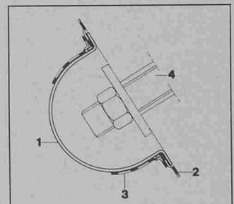
Felsanker. 1 Stahlabdeckhaube mit PVC-Sinterüberzug. 2 Kunststoffdichtungsbahn (KDB). 3 KDB-Zusatzschleife. 4 Anker
