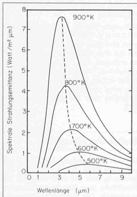
se Farbgliederung entspricht einer Wellenlängenmodifikation der Strahlung je nach Temperatur. Jeder Körper, dessen Temperatur über dem absoluten Nullpunkt ( $-273\text{ °C}$ ) liegt, sendet eine Wärmestrahlung aus. Diese Strahlung ist für das menschliche Auge erst bei hohen Temperaturen sichtbar. Bei normalen Temperaturen liegt sie im Infrarotbereich des elektromagnetischen Spektrums.
