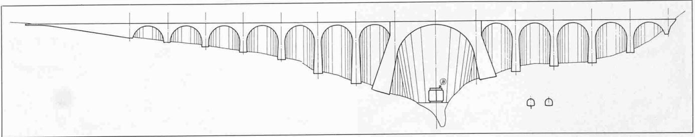
Bild 12. Reihengewölbemauer Manicouagan 5, Kanada (Techniques Audio-Visuelles, Quebec)
