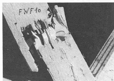
Bild 14. Bruch der Zugdiagonalen ausgehend von einem Ast im Anschlussbereich
