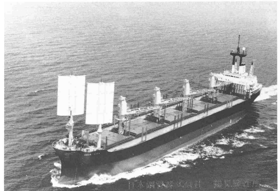
Bild 4. Massengutfrachter «Aqua City» mit Stahlsegeln. Dieselmotor Sulzer-6RTA-58
