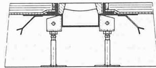
statischen Höhe/Montagekomfort, Einbau in einem Arbeitsgang, keine Aussparung dank verstellbaren Einbaustützen/Senkung der Montagekosten.
