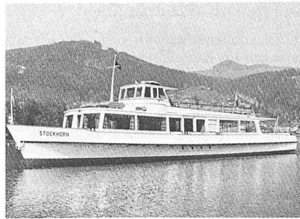
MS Stockhorn 2-Deck-Salon-Motorschiff mit Schraubenantrieb, Tragkraft 250 Personen, Erbauer: Schiffswerft Linz AG, 1974
