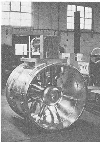
wurden. Die neuen Ausführungen sind wie die Standardventilatoren mit einem Luftradurchmesser von 500-2000 mm verfügbar. Die Motoren befinden sich wahlweise am Ventilatorengehäuse oder auf einem Grundrahmen.
